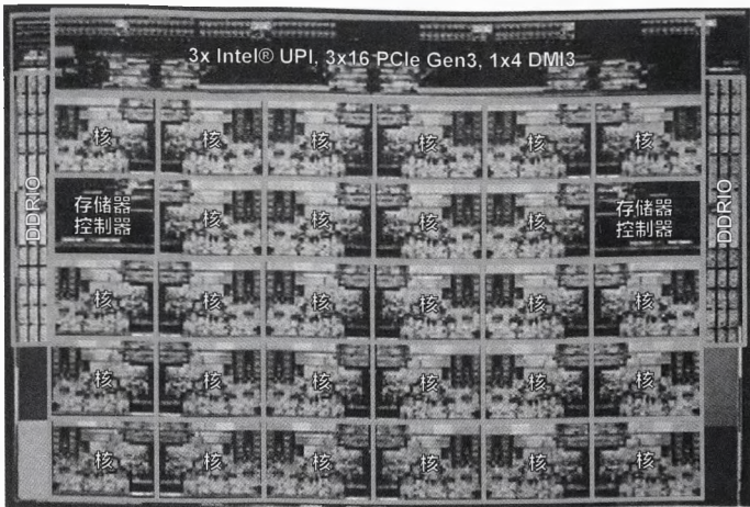
图 1-8 图 1-7 中微处理器晶片的组成及其功能
