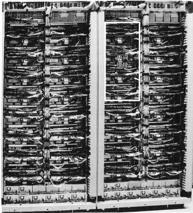
图 6-18 机架中容纳的 Jupiter 交换机的中间模块。一个机架中放置了 4 个中间模块。 一个机架可以容纳两个 spine 模块
